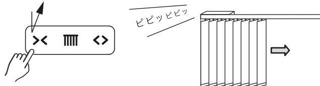
2.閉じ位置が決まったら操作ボタンを左右同時に押し『ピ—————』という音に変わったら手を離します。これで「閉じ位置」が設定されます。
