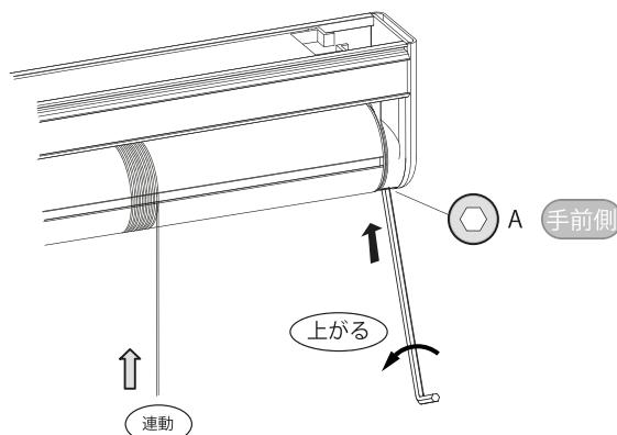
※六角レンチで調節ねじを左に回すと、連動してモーターが作動しカーテンを巻上げます。最適な閉じ位置に調節してください。
