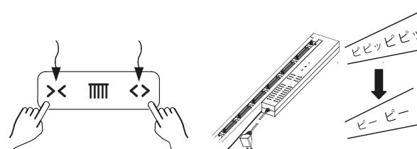
2.さらに、リモコンの操作ボタンを左右同時に短押し『ピー』という音に変わったら手を離します。これですべての位置設定が解除されます。
