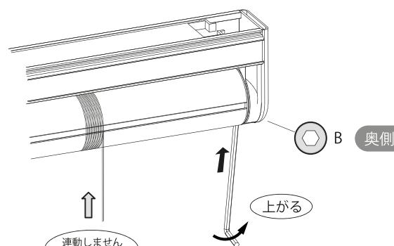
※調節ねじを右に回しても、モーターは連動して動きません。「ねじを6回まわすとローラーバイブコードリールが1回転する」ことを目安にして上に調節してください。
