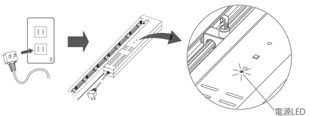
●電源プラグをコンセントに差し込むと自動的にランナーが動き出します。周囲の安全を確認した上で電源プラグをコンセントに差し込んでください。
