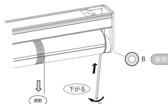
※六角レンチで調節ねじを左に回すと、連動してモーターが作動しカーテンが下がります。最適な開き位置に調節してください。
