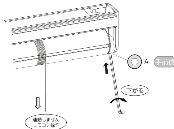
※調節ねじを右に回しても、モーターは連動して動きません。「ねじを6回まわすとローラーバイブコードリールが1回転する」ことを目安にして下に調節してください。
