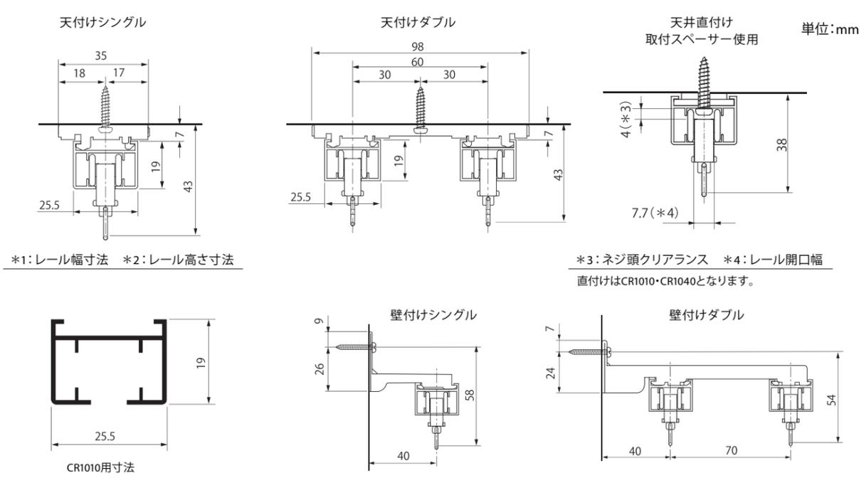
■ CR1010 カーテンボックス納まり図 (直線レール)
