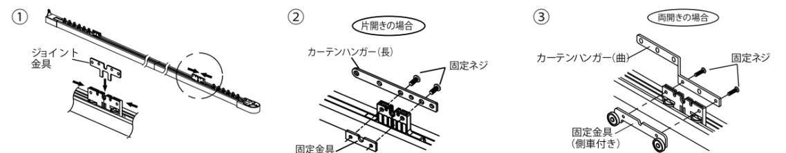
■ カーテンボックス納まり図 (直線レール)
