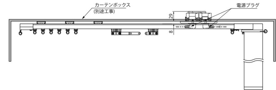
【参考図】 埋込設置ダブルコンセント パナソニック製 WN115217SW (詳細は製品仕様書をご覧ください。)
