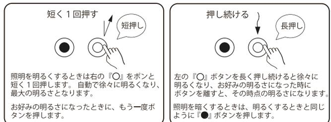
※ 照明スイッチ (LC6200S、LC6300S) の場合は『短押し』でも 『長押し』でもリモコンボタンの『○』がON、『●』がOFFです。
