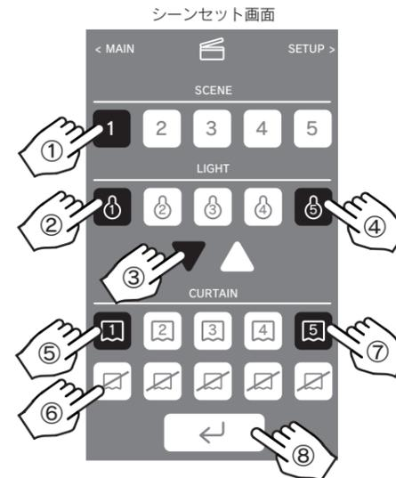
4. カーテンの開閉予約を設定する場合は、⑤カーテンの「ID番号1」にタッチしてハイライトします。⑥カーテンの開閉アイコンをタッチし、「開閉せず」→「開く」→「閉じる」に順次変更して、設定します。
