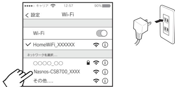
一覧の中からNasnos-CS8700\_XXXXを選択し接続し、パスワードを入力してください。パスワードは「CS8700Hxxxxxx」で英数字13桁となります。先頭の7桁は固定で「CS8700H」、下6桁は英数字は本体背面の右下ラベルを参照してください。(5ページ参照)
