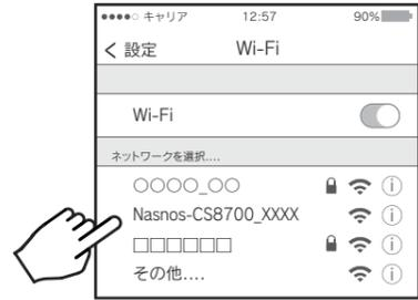
2. 一覧の中からNasnos-CS8700\_XXXXを選択し接続し、パスワードを入力してください。パスワードは「CS8700Hxxxxx」で英数字13桁となります。先頭の7桁は固定で「CS8700H」、下6桁は英数字は本体背面の右下ラベルを参照してください。(5ページ参照)
