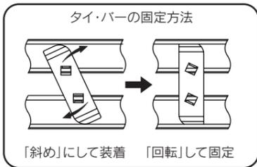
※ 仕上幅2m以上の長いレールにタイ・バーを取付けます。
