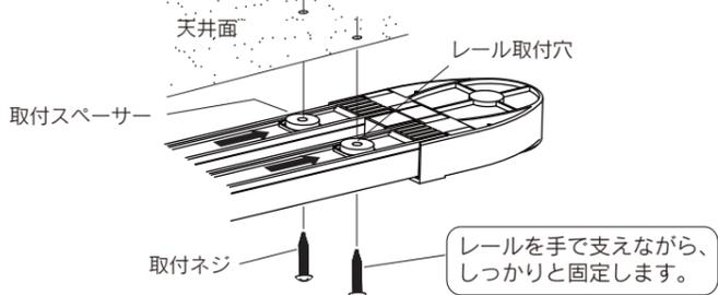
3 同様にして、すべてのレール取付穴を取付けネジで固定します。
