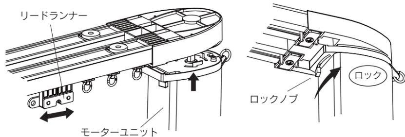
4 付属の電源コードを底面のコネクタに接続して組み立ての完了です。電源コードは奥までしっかりと差し込んでください。有線仕様でお使いの場合はモジュラージャックを挿し込んでください。
