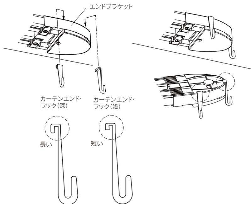
5 これでカーテンエンド・フックの取り付けが完了です。モーターユニットの取り付け後、カーテンを引っ掛けます。
