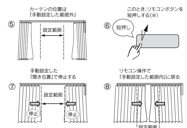
\* リモコンボタンの「短押し」操作で、自動設定した開閉位置から手動設定位置にカーテンを戻す場合は注意が必要です。9ページの「手動設定」を行う際に、手動設定位置は自動設定の位置から「4cm以上」離して設定してください。
