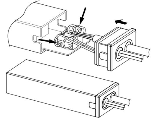
7 機器のケーブルを本体に取り付けた後、電源プラグをコンセントに差し込みます。
