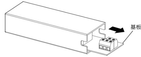
4 基板上的入力端子に電源線、出力端子に機器側のケーブルを接続します。
