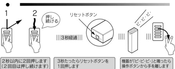
2秒以内に2回押しします (2回目は押し続けます)      3秒たったらリセットボタンを1回押しします      機器が「ビ・ビ・」と鳴ったら操作ボタンから手を離します
