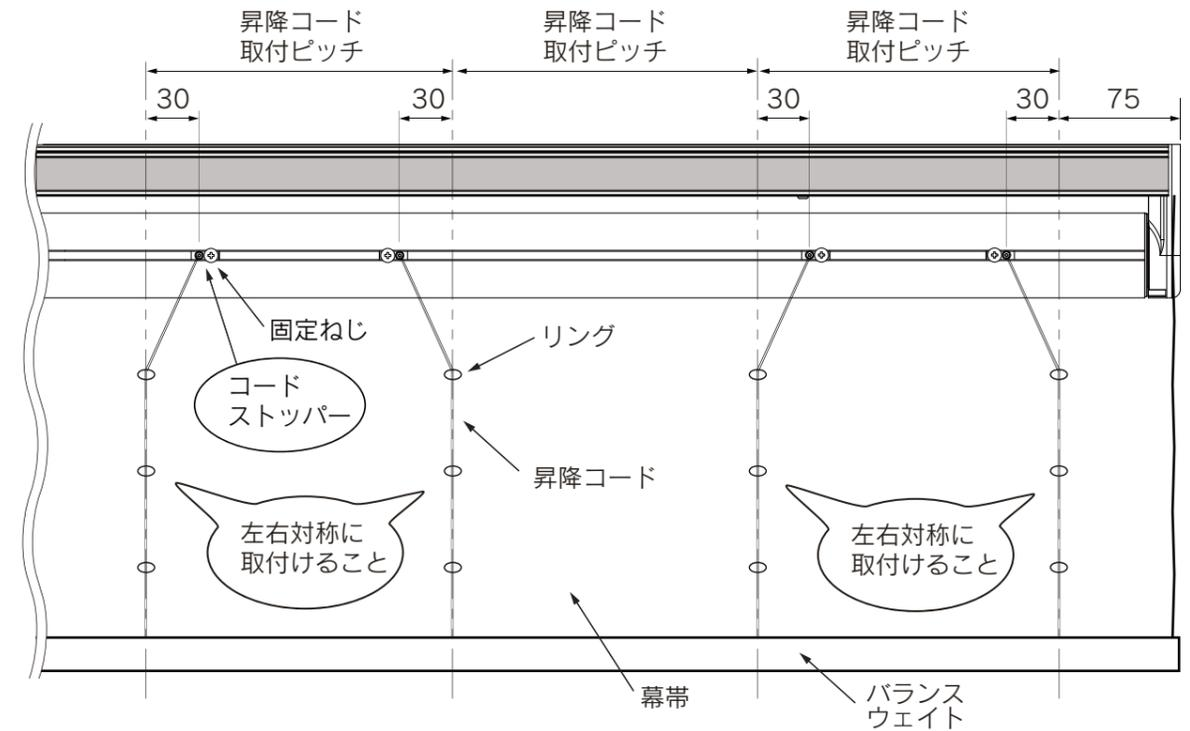
5. レールのマジックテープ部に幕帯を貼付けます。幕帯の下部にボトムウェイトなどを取付けた後、昇降コードをリングの上から順次に通します。最後はカーテン下部で固定してください。
