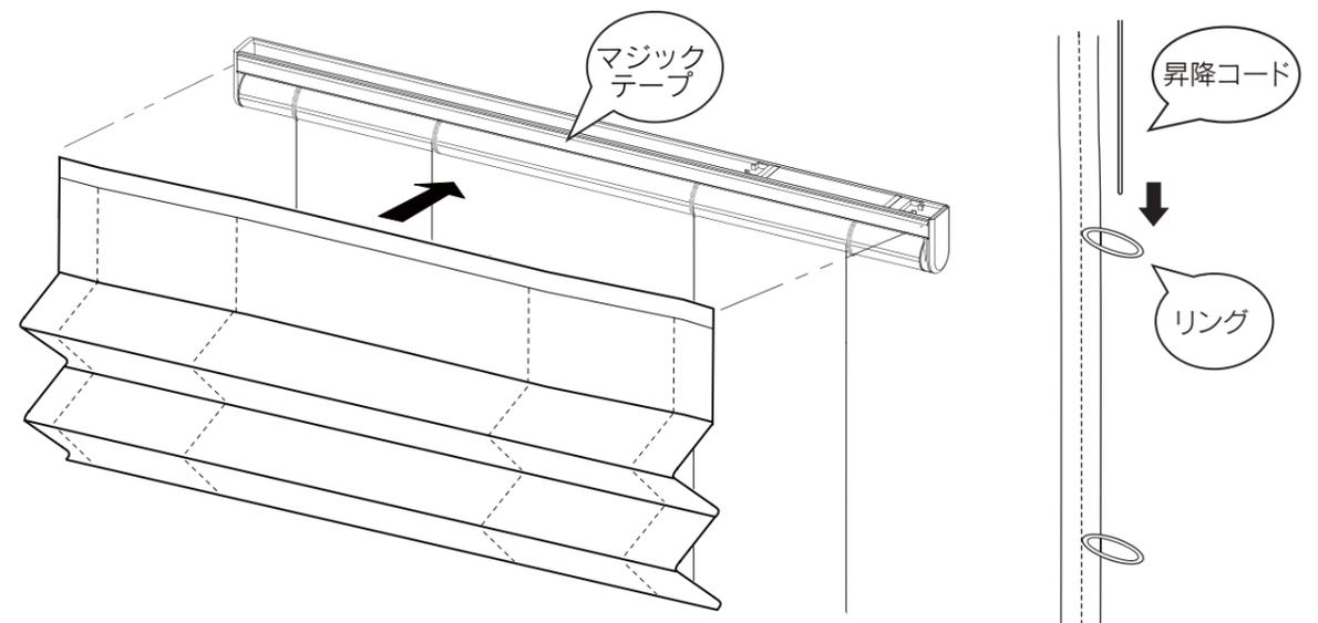
6. 幕帯の取付が完了したらリモコンボタンの右側（開く）を押して、幕帯を巻き上げてください。このとき、昇降コードがからまないことを確認してください。
