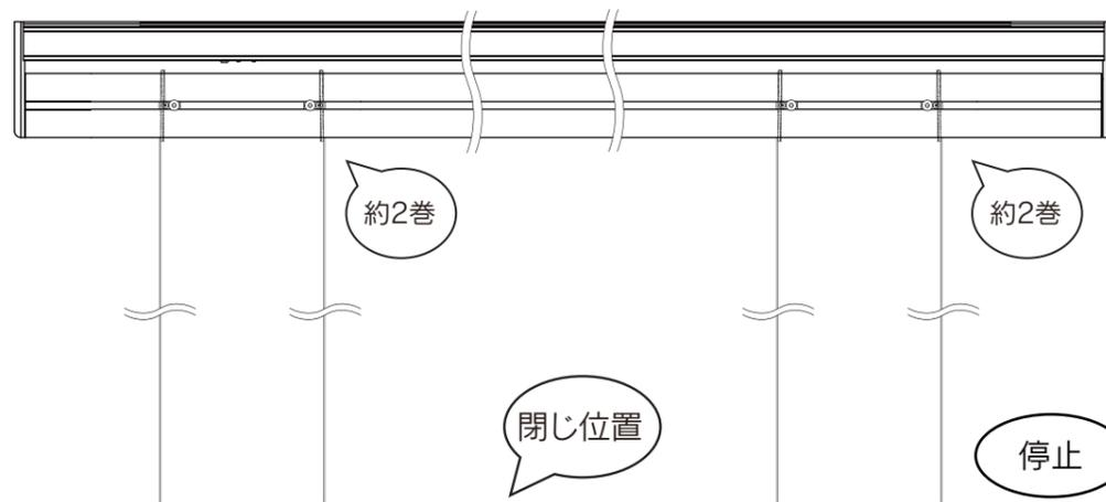
4. コードストッパーの固定ねじを緩めて左右に調節し、下図のように昇降コードの「取付ピッチ」から30ミリ程度ずらしてください。このとき、「左右対称の配置」としてください。
