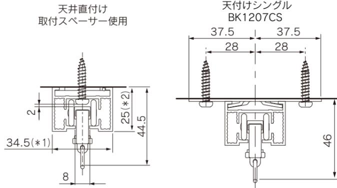
\*1: レール幅寸法 \*2: レール高さ寸法
