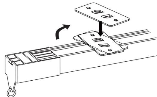
2 ブラケットの固定作業の完成後に天井面に取り付けます。各ブラケットをそれぞれ2本の取付ネジで固定します。
