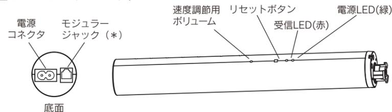
※ 受注生産でご購入された有線専用モデルの場合、このモジュラージャックに有線スイッチを接続して操作します。
