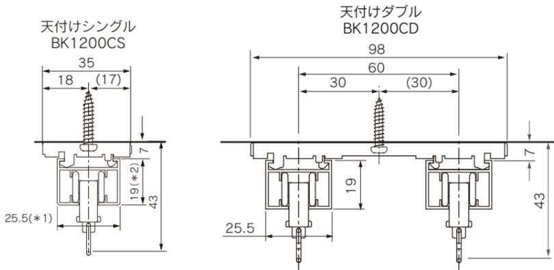
\*1: レール幅寸法 \*2: レール高さ寸法
