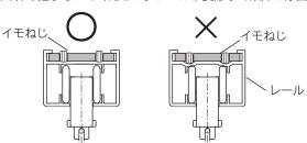
3 レールの接続が完了したら、分割型リードランナーの中央のスリットにジョイント 金具を差し込みます。
