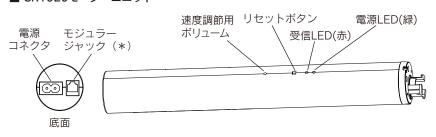
※ 受注生産でご購入された有線専用モデルの場合、このモジュラージャックに有線スイッチを 接続して操作します。
