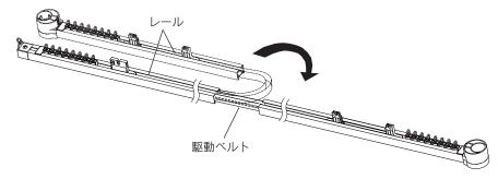
2 連結板で2つのレールを接続します。六角レンチ(H2)で付属のイモねじを連結板の片側を固定します。差し込みが完了したらもう一方を固定します。その際に駆動ベルトを挟み込まないように、分割型リードランナーを移動して近づけます。
