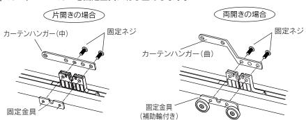
5 両開きの場合は、もう一方にカーテンハンガー(短)を差し込みます。これでレールの組立作業が完了です。
