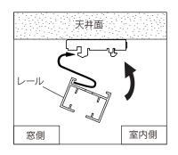
※ ブラケットの奥側のフックを引っかけて手前側を押し込みます。 ※ ブラケットは500mm~800mm間隔で設置してください。
