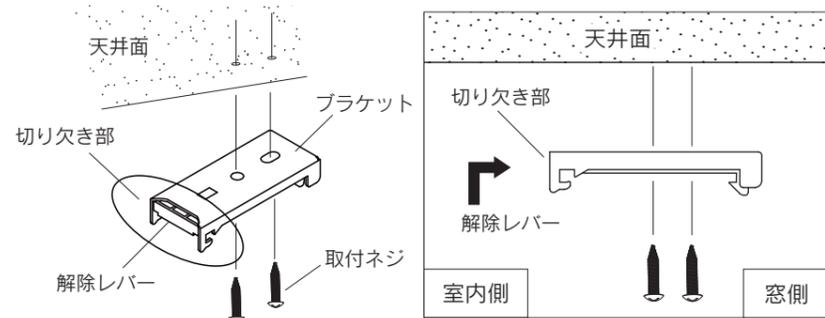
※ ブラケットは解除レバーのある「切り欠き部」を室内側に向けて取り付けます。
