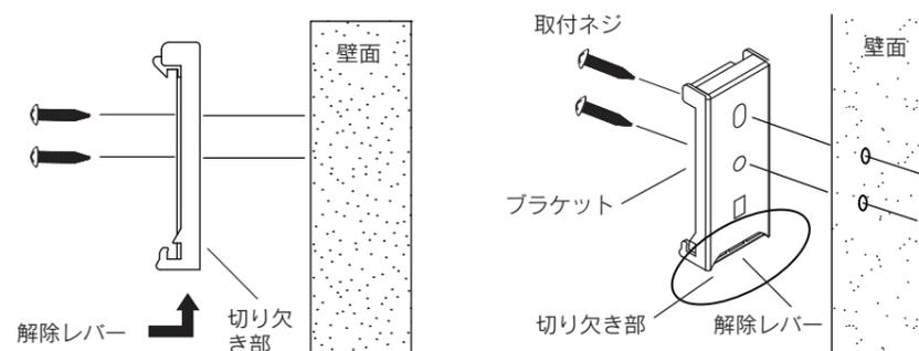
※ ブラケットの解除レバーのある「切り欠き部」を下側に向けて取り付けます。
