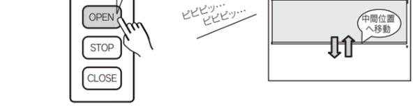
※「位置設定モード」に入ると、「長押し」操作ではスクリーンの昇降速度は低速回転となります。(「短押し」操作の昇降速度は変わりません)
