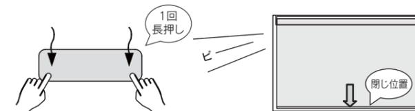
6B 『閉じ位置』の設定が完了すると、自動的に通常モードに戻ります。昇降スピードも通常のスピードに戻ります。
