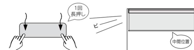
6C 『中間位置』の設定が完了すると、自動的に通常モードに戻ります。昇降スピードも通常のスピードに戻ります。
