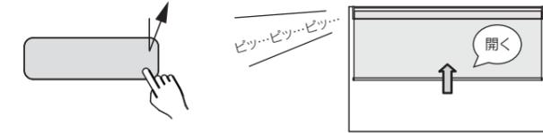
※ 『位置設定モード』に入ると、『長押し』操作ではスクリーンの昇降速度は低速回転となります。（『短押し』操作の昇降速度は変わりません）
