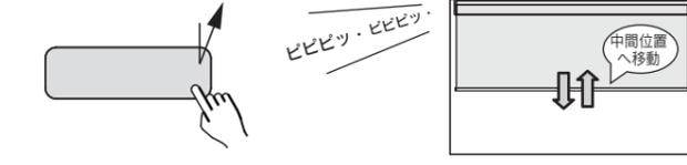
※ 『位置設定モード』に入ると、『長押し』操作ではスクリーンの昇降速度は低速回転となります。（『短押し』操作の昇降速度は変わりません）
