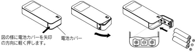
図の様に電池カバーを矢印の方向に軽く押し戻します。
