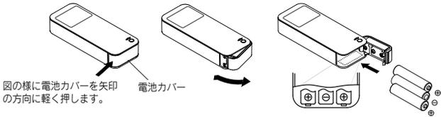
図の様に電池カバーを矢印の方向に軽く押し戻します。
