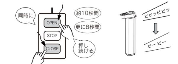
2 さらに、外部スイッチの「OPEN」と「CLOSE」を同時に短押しし、「ピー———」という音が変わったら手を離します。これですべての位置設定が解除されます。
