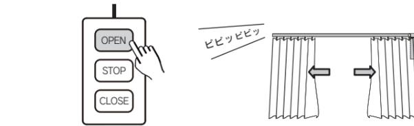
2 開き位置が決まったら外部スイッチの「OPEN」と「CLOSE」を同時に長押しします。「ビ———」という音が変わったら手を離します。これで「開き位置」が設定されます。
