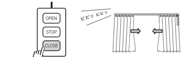
2 閉じ位置が決まったら外部スイッチの「OPEN」と「CLOSE」を同時に長押しします。「ビ———」という音が変わったら手を離します。これで「閉じ位置」が設定されます。
