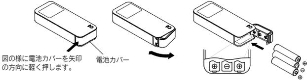
図の様に電池カバーを矢印の方向に軽く押します。
