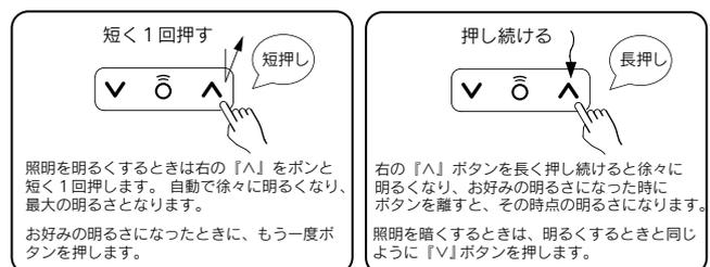
※ 照明スイッチ (LC6200S, LC6300S) の場合は「短押し」でも「長押し」でも操作ボタンの「^」がON、「V」がOFFです。
